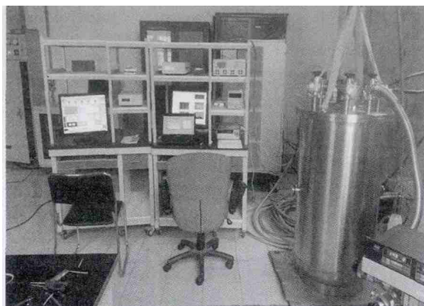
图 4 制冷机直接冷却式小型超导磁测试装置
