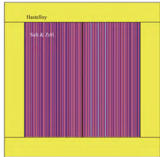
图 4 氢化锆慢化熔盐热堆模型 Fig.4 Schematic model of the ZrH-moderated MSR.
