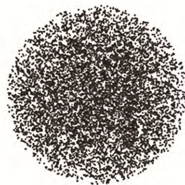
图 1 球形燃料元件内包覆燃料颗粒空间分布示意图 Fig.1 Schematic diagram of particle distribution in pebble.
