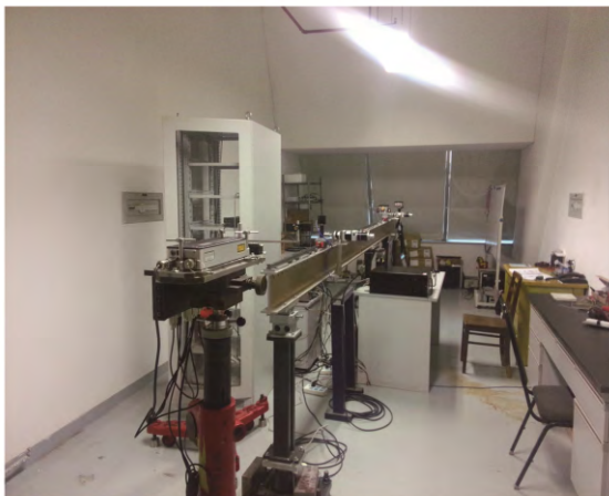
图 7 PSD 位置测量系统 Fig.7 PSD position measuring system.
